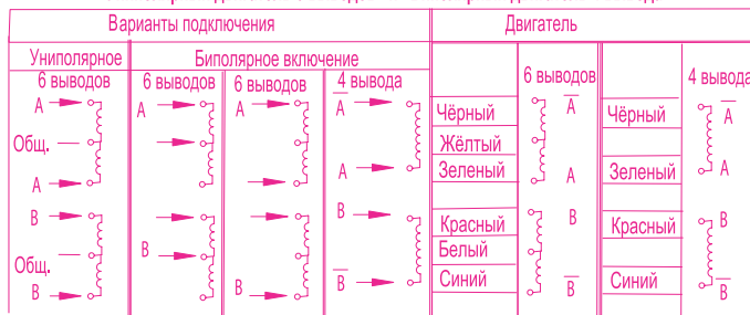
Униполярный двигатель 6 выводов и Биполярный двигатель 4 вывода
